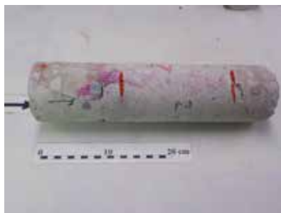
1. Testimoni de formigó d'un forjat afectat pel foc a la cara inferior (dreta). FONT: laboratori CECAM.
