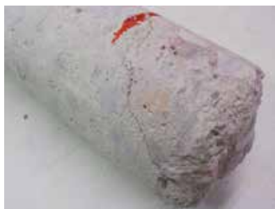
3. Detall de la part inferior del testimoni. Zona afectada pel foc. FONT: laboratori CECAM.
