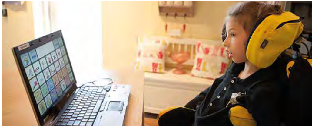
Sistema de control d'entorn i de comunicació mitjançant la mirada en habitació d'hospital.
