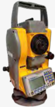
Teodolit Trimble M3.
