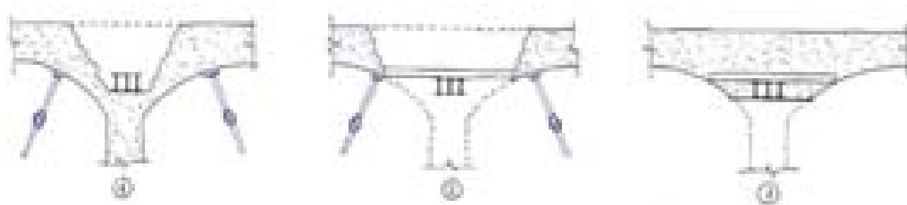
Figura 6. Procés d'obertura del mur en la sala de premsa:
