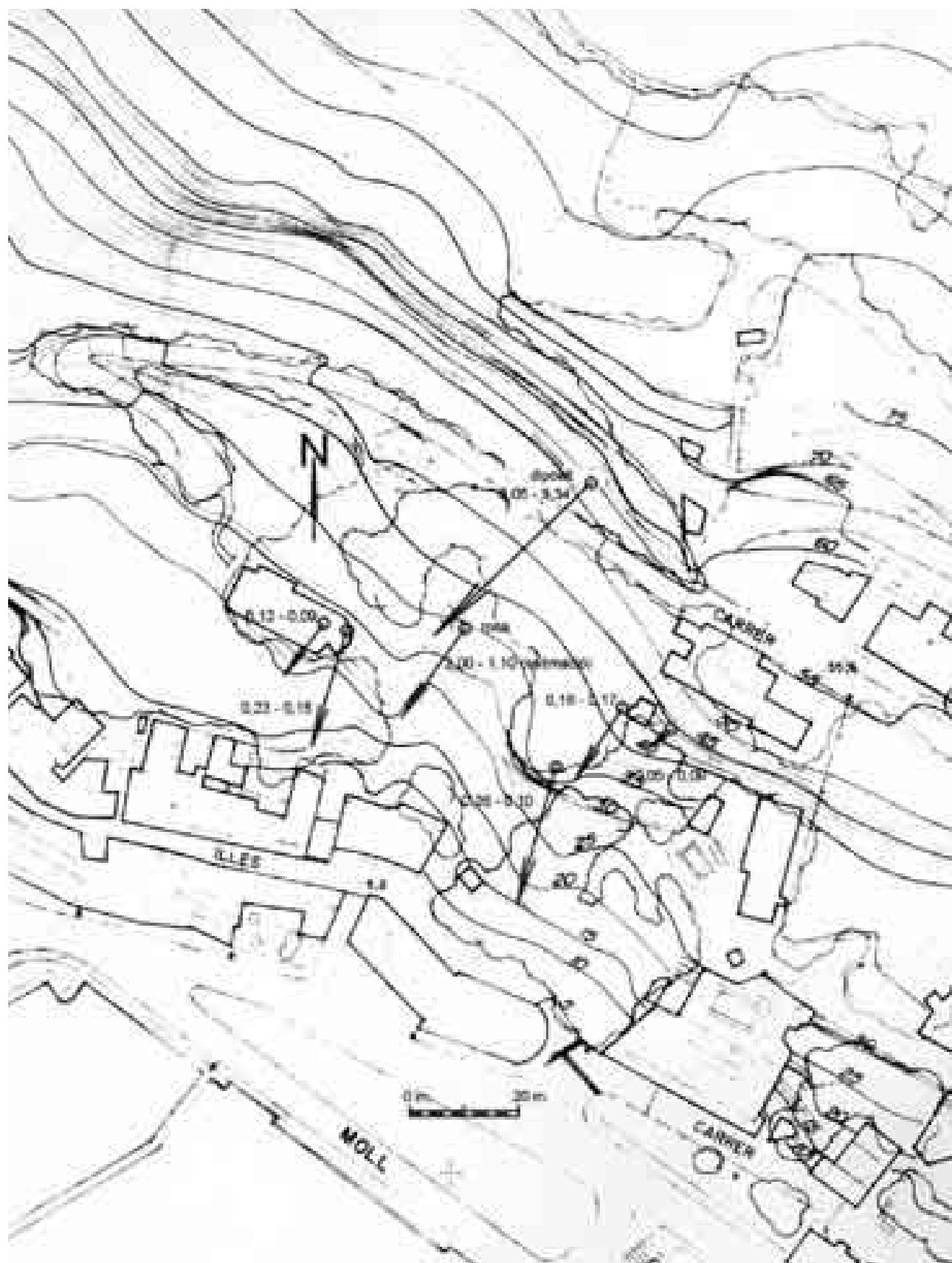
Croquis 1: Moviment de diferents punts observats entre el 4 i el 21 de novembre de 1994. Les fletxes estan a escala proporcional al desplaçament excepte les del dipòsit i de la roca, amb moviment força superior a la resta. Els nombres expressen els desplaçaments horitzontal i vertical (metres) observats durant aquests dies.
