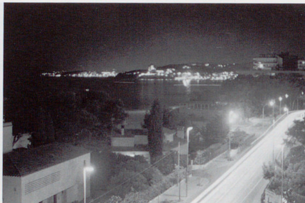
Les làmpades de vapor de sodi, amb menys consum, il·luminen més que les de mercuri. (Foto: X.B.)
